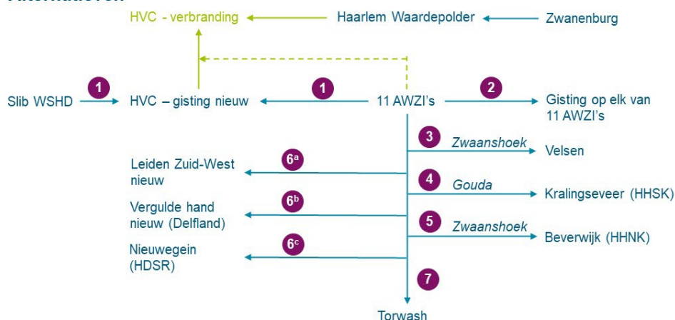
Figuur 3 Schematische weergave van boven: huidige centrale gisting op HWP en onder de in deze studie onderzochte alternatieven. Aan de linkerkant van de alternatieven zijn de meer centrale alternatieven weergegeven, aan de rechterkant de decentrale opties. Torwash zit daar als alternatief tussen in.
