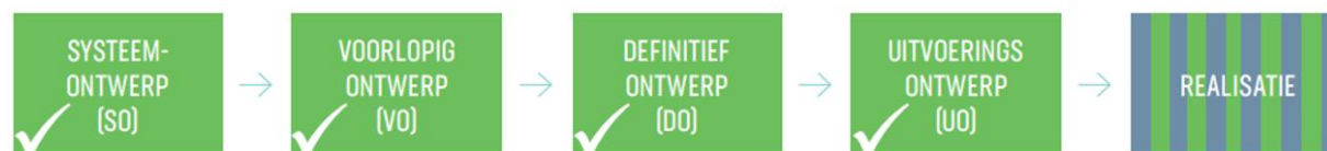
Figuur 16: Fasering van ontwerp naar uitvoering (groen is gereked)
