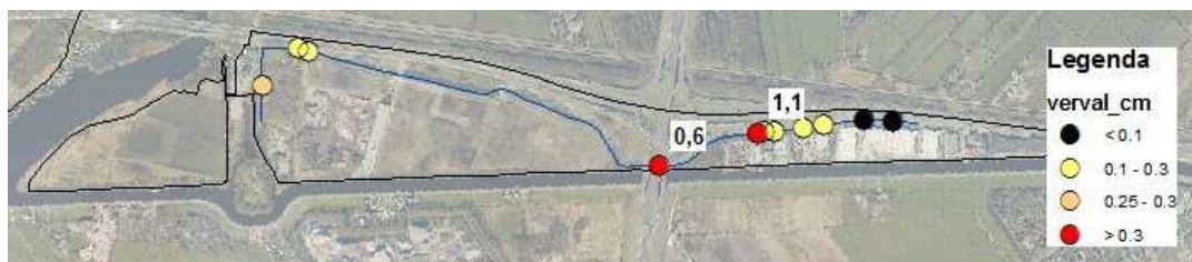
Figuur 5.1: duikers die niet voldoen aan de norm in Rottepolder (rood)
