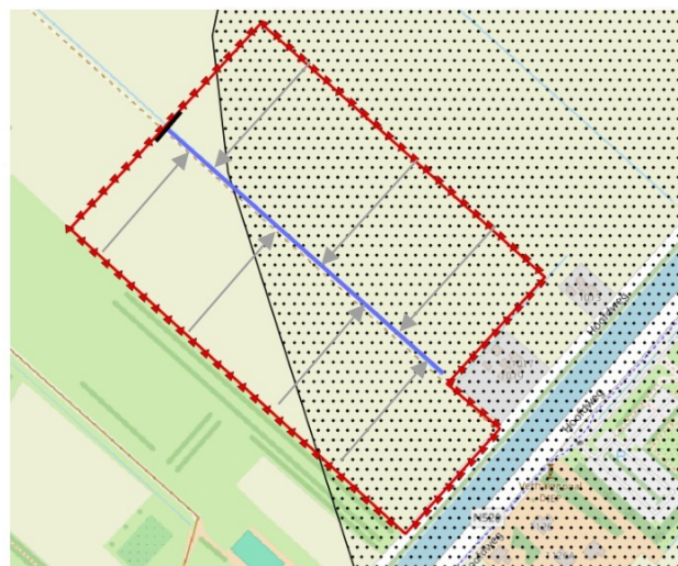
Figuur 5 - bovenaanzicht proef, gearceerd gebied met stippen is geulafzetting, blauwe lijn is sloot waaruit debiet is gemeten, zwart is de tijdelijke stuw en rode lijn met driehoeken geeft drainagegebied aan (drains binnen dit gebied stromen af in de sloot)
